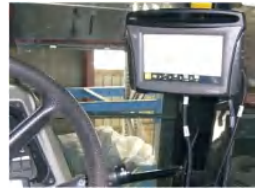
トラクタ車内に設置されているRTK-GPSシステム本体
